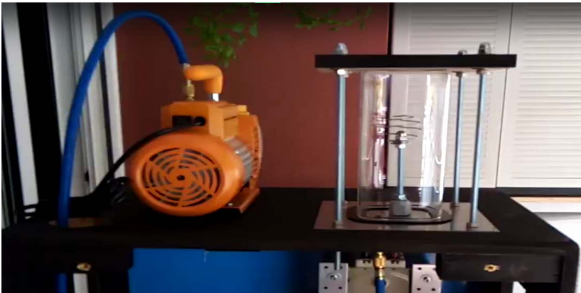
Figura 56: Prueba de vacío del fusor Aaries
